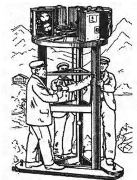
Fig. 2. Camera configuration for Raoul Grimoin-Sanson's Cinécosmorama or 'Cineorama', patented on 27 November 1897 @ Cinémathèque Française.
